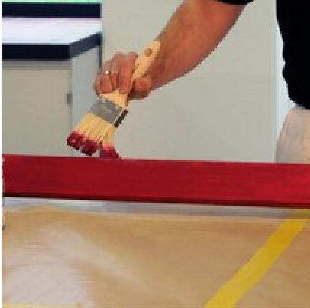
...und streichen Sie mit einem **Wasserlackpinsel** zügig über die einzelnen Bretter. Um Lacknasen und Tropfen zu verhindern, sollten Sie die einzelnen Teile liegend lackieren. Lassen Sie die Bretter 5-6 Stunden trocknen und streichen Sie anschließend die Rückseite.
