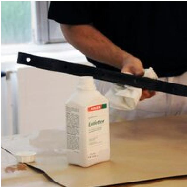
Für die gründliche Reinigung schleifen Sie mit einem **Schleifvlies** und **ADLER Entfetter** über die Metalloberflächen. Nach 5-10 min Einwirkzeit können Sie mit klarem Wasser nachwaschen und alles trocknen lassen.
